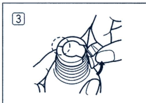
③ 矢印の方向(反時計まわり)に動かすと、反対側のスリットが割れます。
