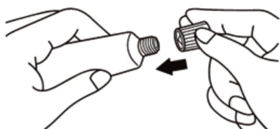
キャップを逆さにして，突起部をチューブの先に強く押し当ててあけてください。
