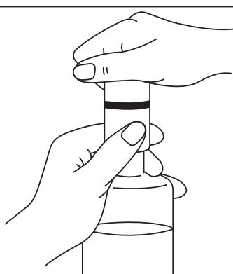
アダプターを持ち、キャップを開封の→方向に回してシールを切り、キャップを外す。
